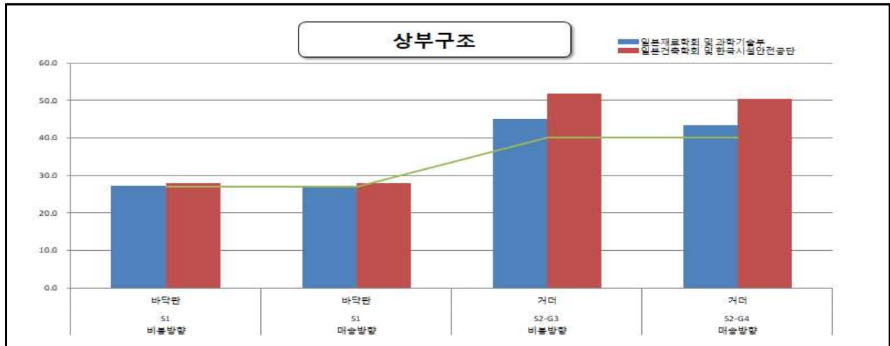
【그림 1.4.3】 상부구조 반발경도시험 측정결과
